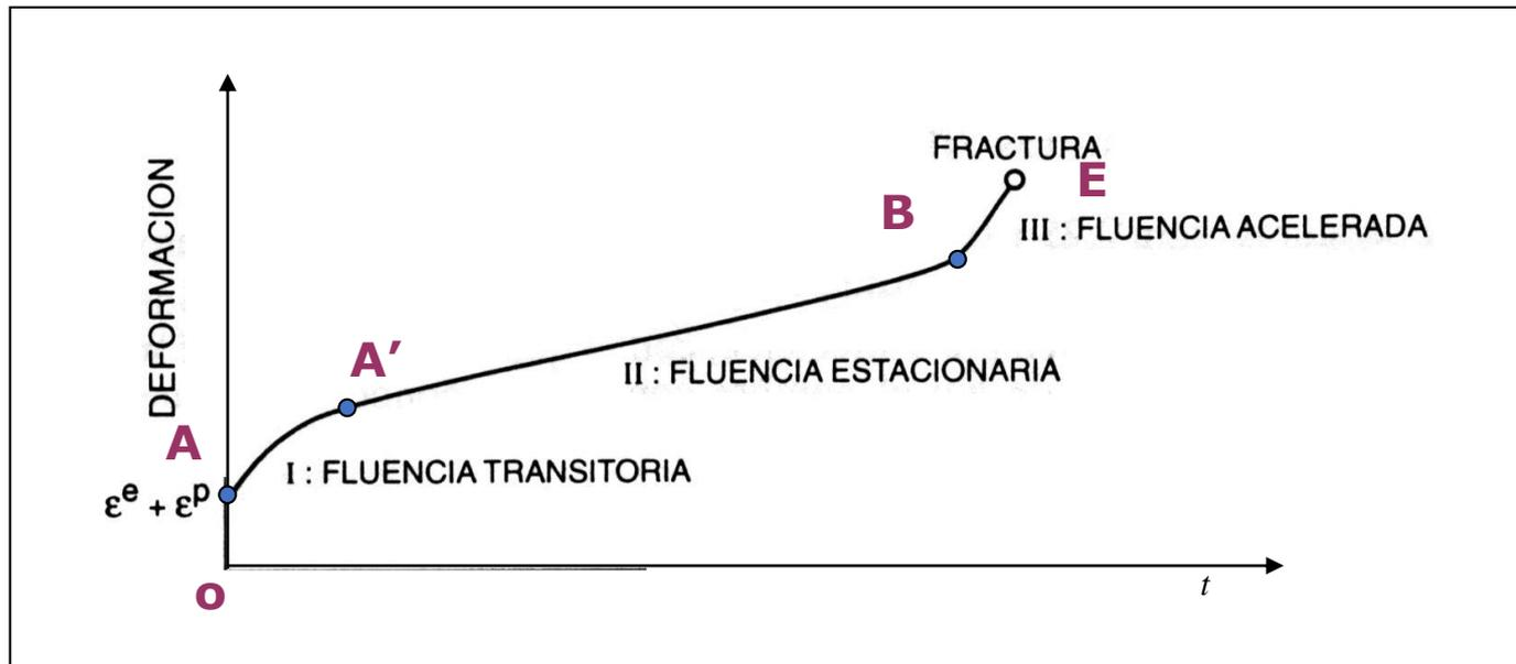
Parte de la deformación lograda en la primera etapa (fluencia primaria o transitoria) puede recuperarse: deformación viscoelástica
